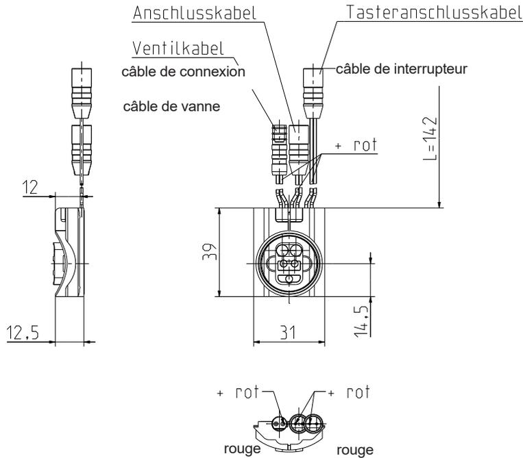
**IR-capteur avec connexion
